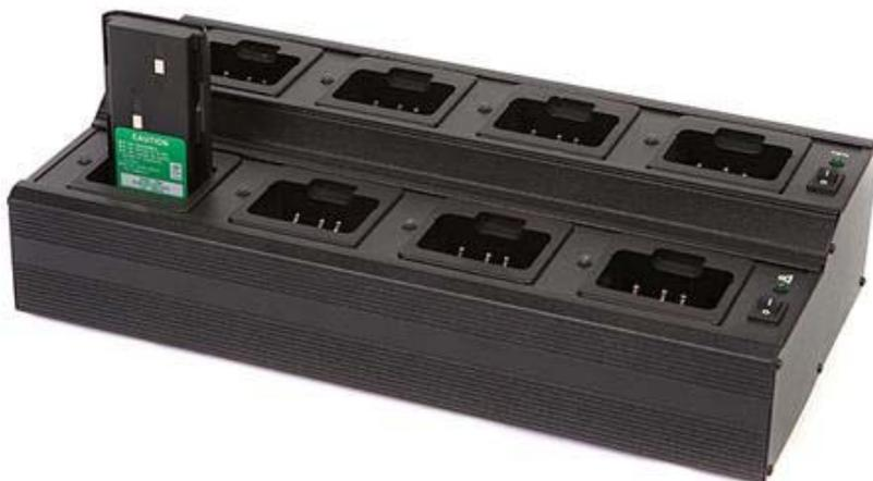
Источник вторичного электропитания ИВЭП-19 предназначены для автоматического группового заряда Ni-Cd и Ni-MH аккумуляторных батарей типа KNB-15 емкостью 1,0-2,1 А/ч и номинальным напряжением 7,2 В.
