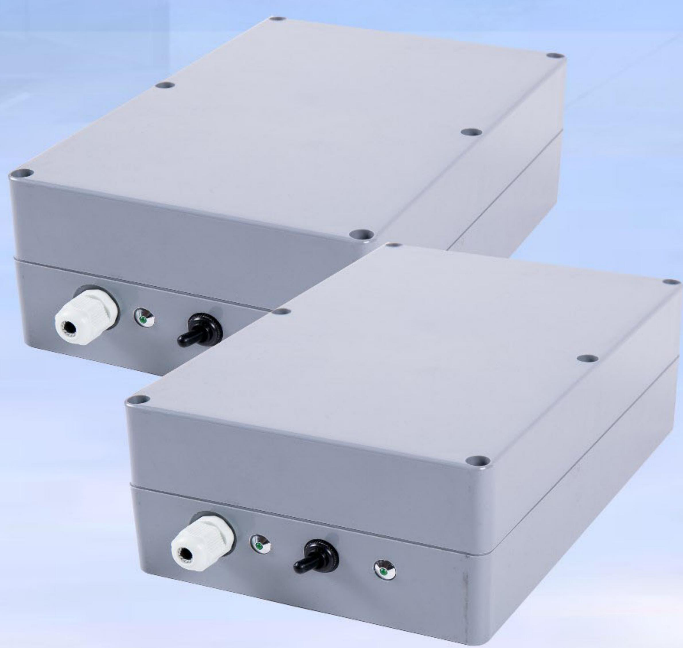
Автономный малогабаритный ретранслятор 2Р48С - предназначен для увеличения зоны покрытия объекта. Имеет моноблоочное исполнение и не требует прокладки антенных фидеров, установки дуплексеров, коммутаторов, разветвителей и т.п. Имеет встроенный бесперебойный блок питания для автономной работы не менее 6 суток. Имеет индикацию состояния работы (вкл, внешн питания, питание от резервного источника)
